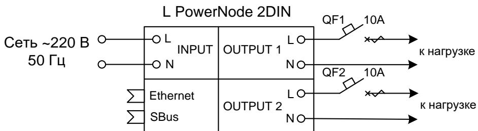
Рисунок 4 – Схема подключения устройства LPowerNode 2DIN
