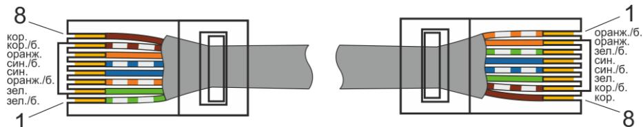
Рисунок 2 – Схема электрическая сетевого кабеля Ethernet 100Base-TX/10Base
